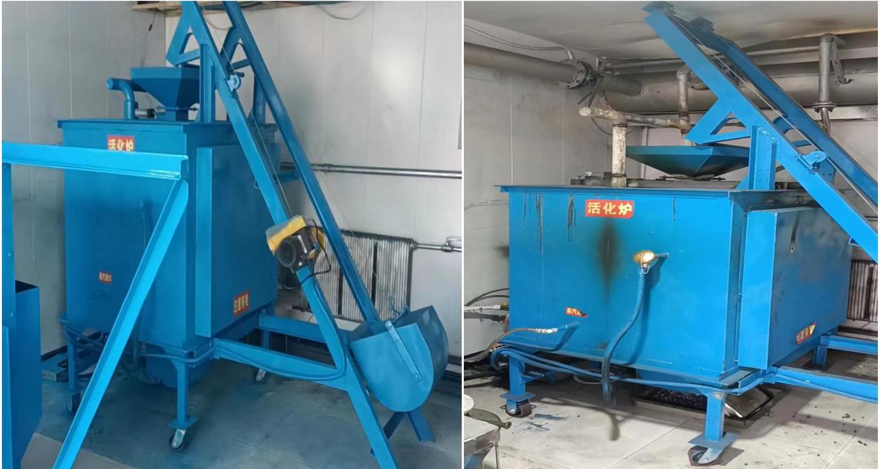
2021 年设计制造了一台穿透式活化炉的中试试验炉
